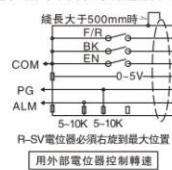
**外部模擬電壓/PWM調速控制**
